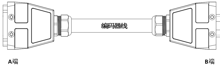
图 9-20 ARC5-280 编码器拖链线示意图
