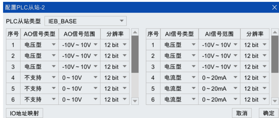
图 21-35 【配置PLC从站】界面参数配置示例
