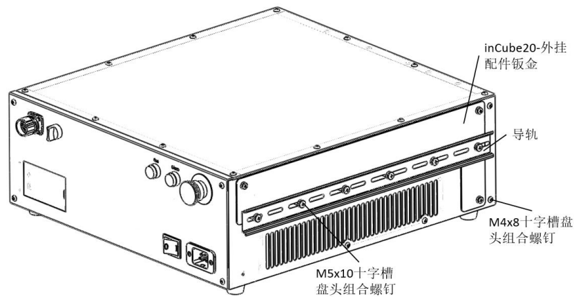
图 16-3 安装 inCube20-外挂钣金与导轨
