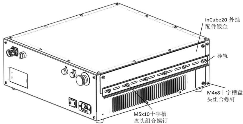
图 16-3 安装 inCube20-外挂钣金与导轨
