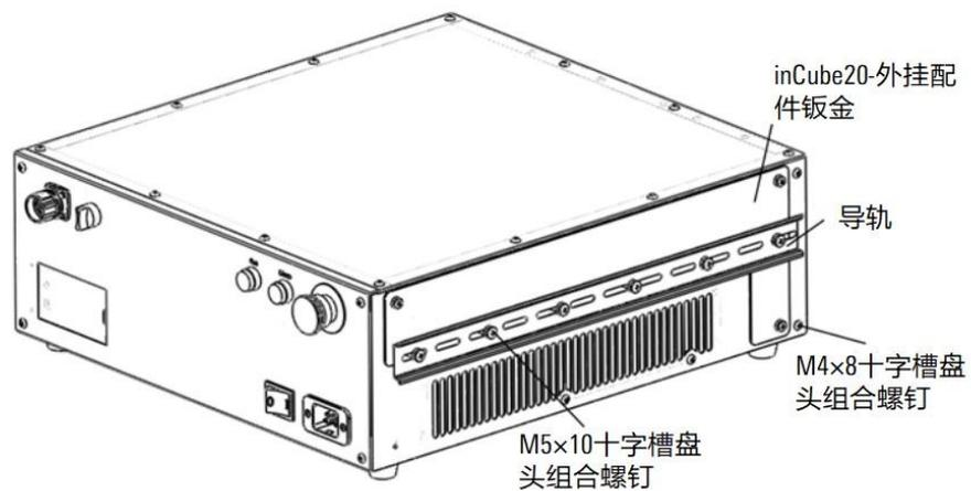
图 18-4 安装 inCube20-外挂钣金与导轨
