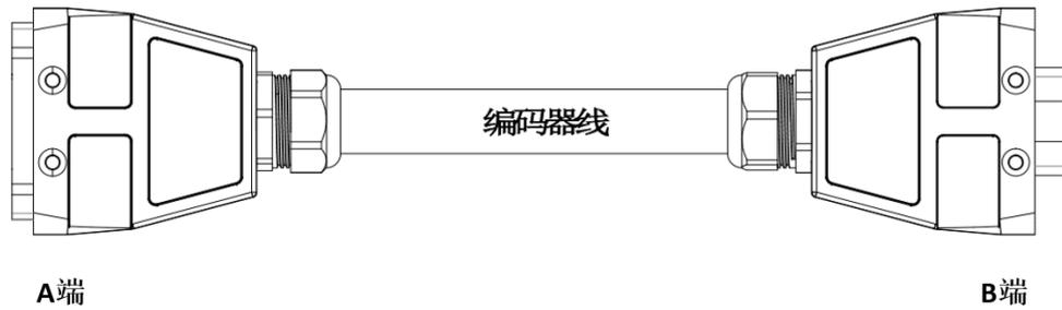
图 9-29 ARC4-50/ARC4-75/ARC4-165 编码器固定线与拖链线外形示意图
