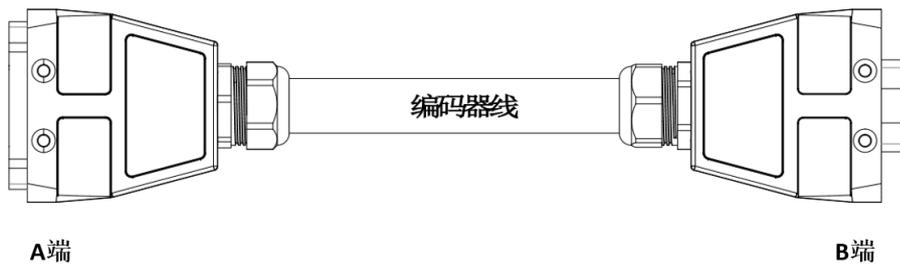
图 9-16 ARC5-280 柜外编码器线束示意图
