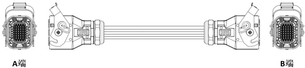
图 9-24 inCube20 重载拖链线外形示意图
