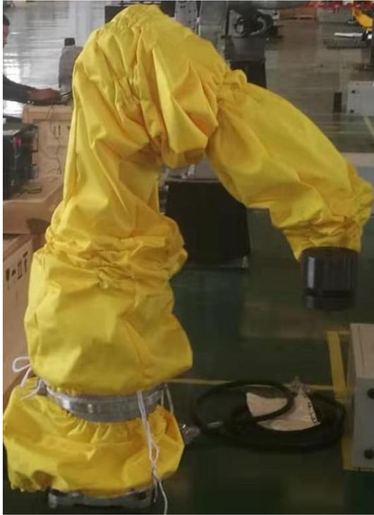
图 2-1 防尘耐磨服示意图
