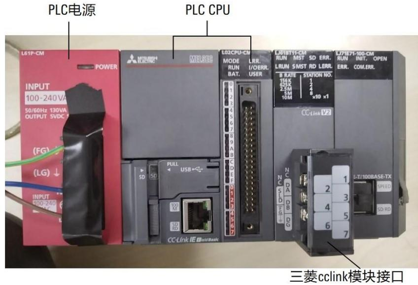
图 17-1 三菱的电源模块、CPU 和 CC-Link 模块
