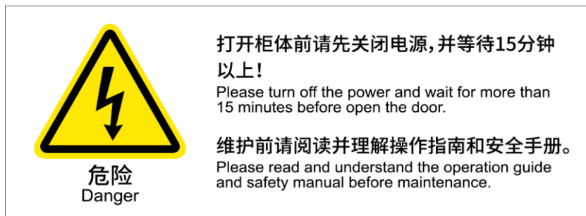
图 2-7 开门断电&amp;维护指示牌
