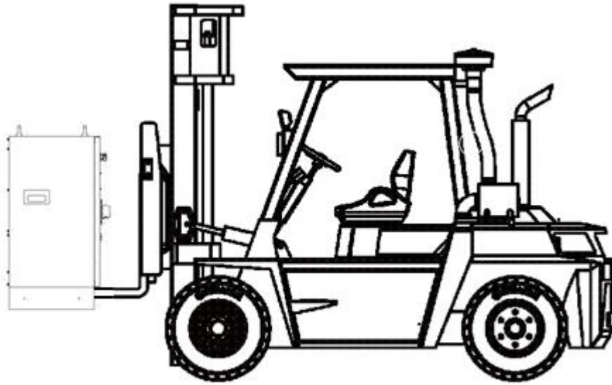
图 2-3 控制柜叉车搬运
