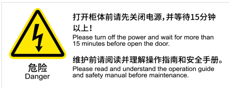
图 1-5 开门断电&维护指示牌
