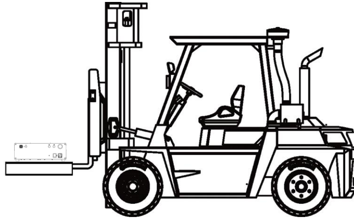
图 2-1 控制柜叉车搬运示意图
