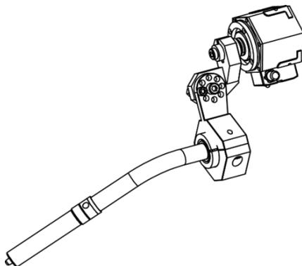
图 5-3 工业机器人用弧焊枪
