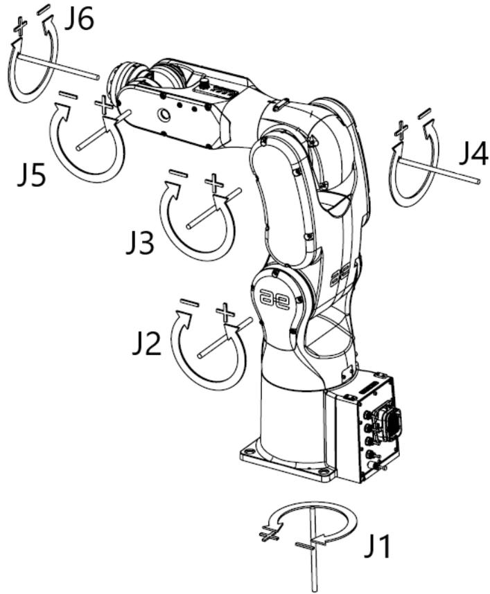
图 6-5 操作机各轴的运动方向
