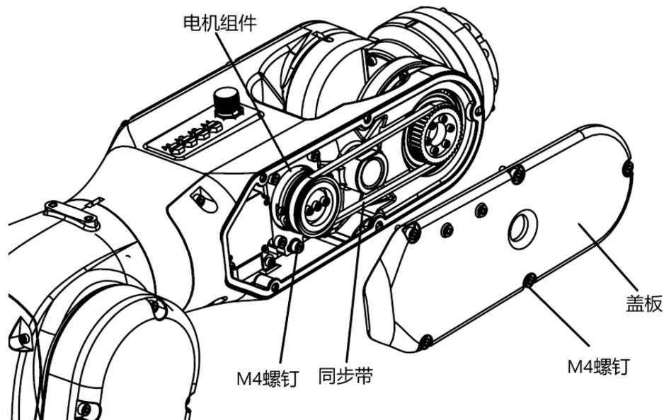
图 10-7 J6 轴同步带更换示意图
