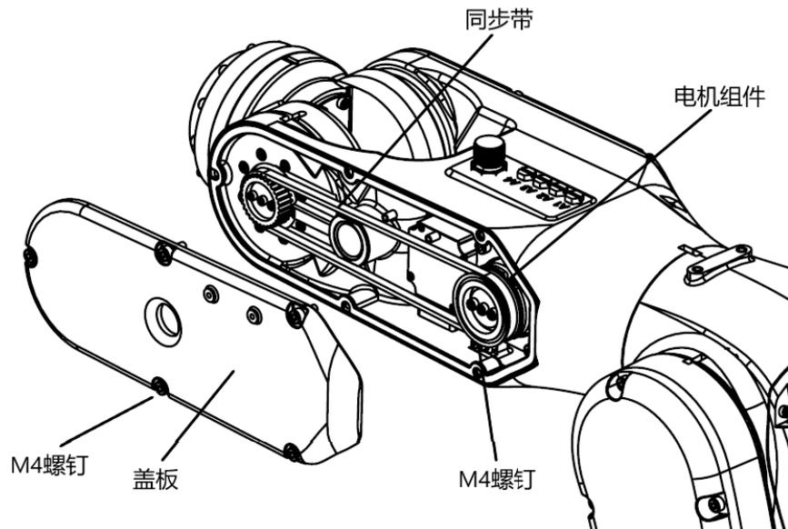
图 10-6 J5 轴同步带更换示意图
