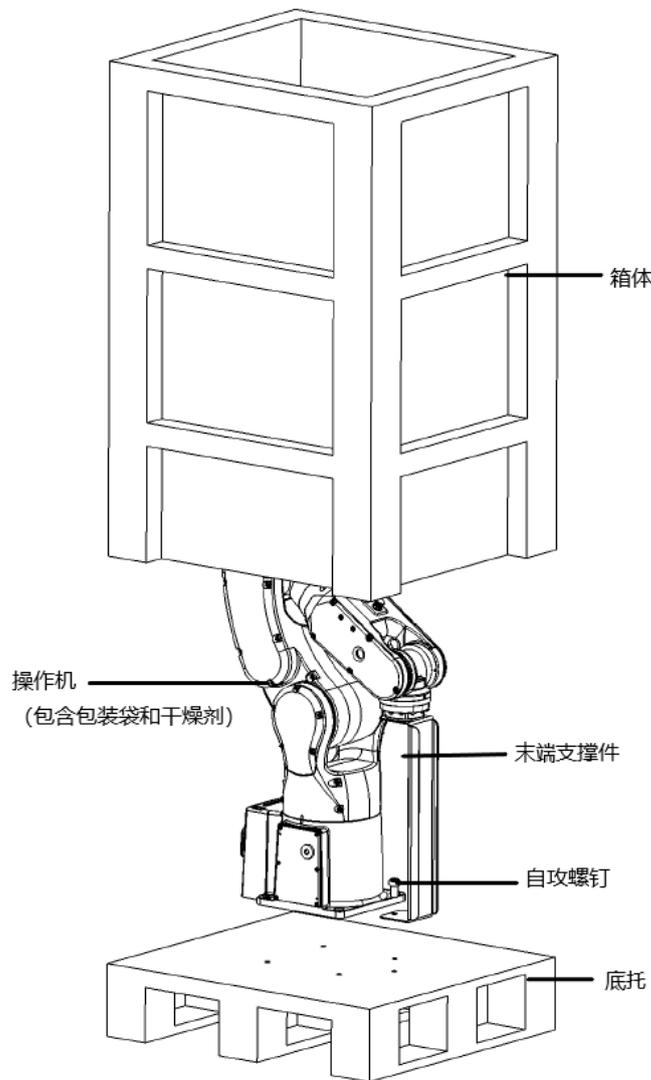
图 3-2 AIR4-560C(-HW)操作机包装箱的构成
