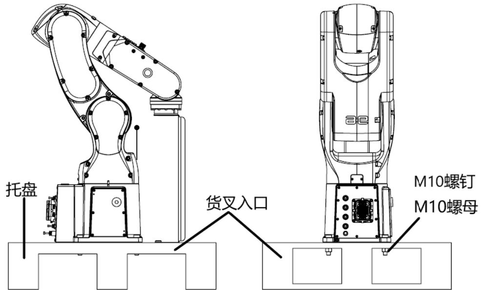
图 7-4 AIR4-560C(-HW)叉车搬运示意图
