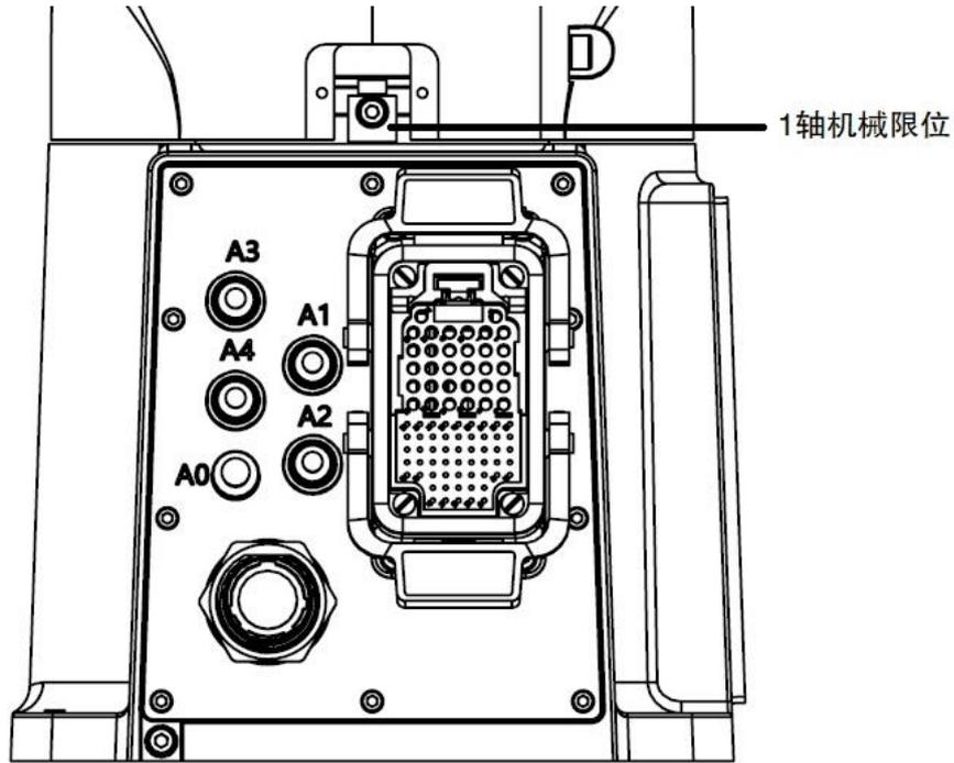
图 6-2 AIR4-560C(-HW)操作机上机械式制动器
