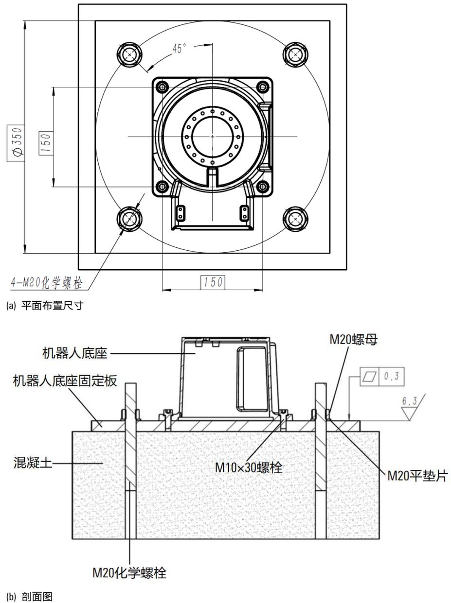
图 3-4 操作机地面固定示意图
