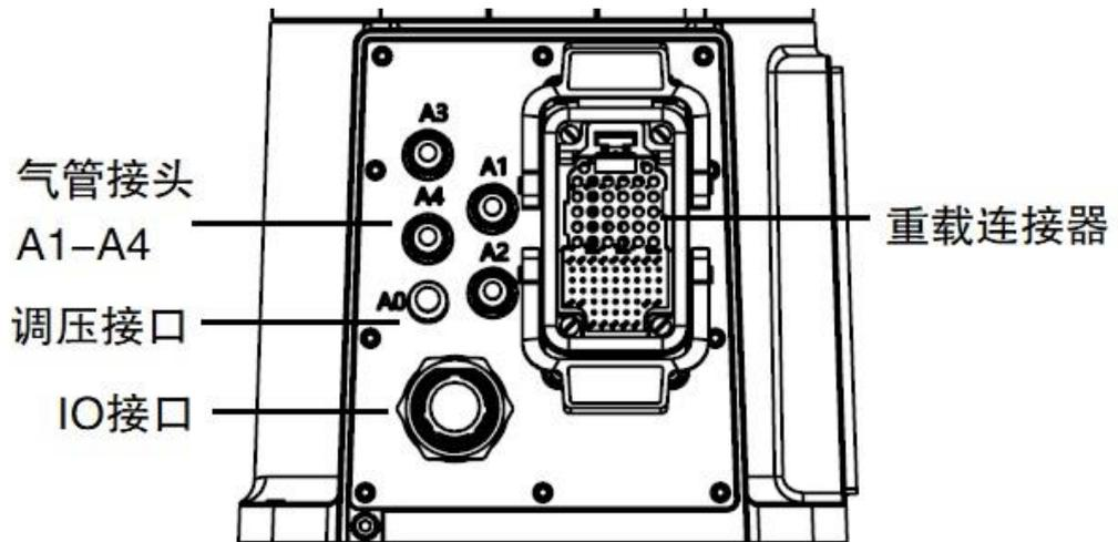
图 4-1 AIR4-560C(-HW)操作机底座上电气接口示意图
