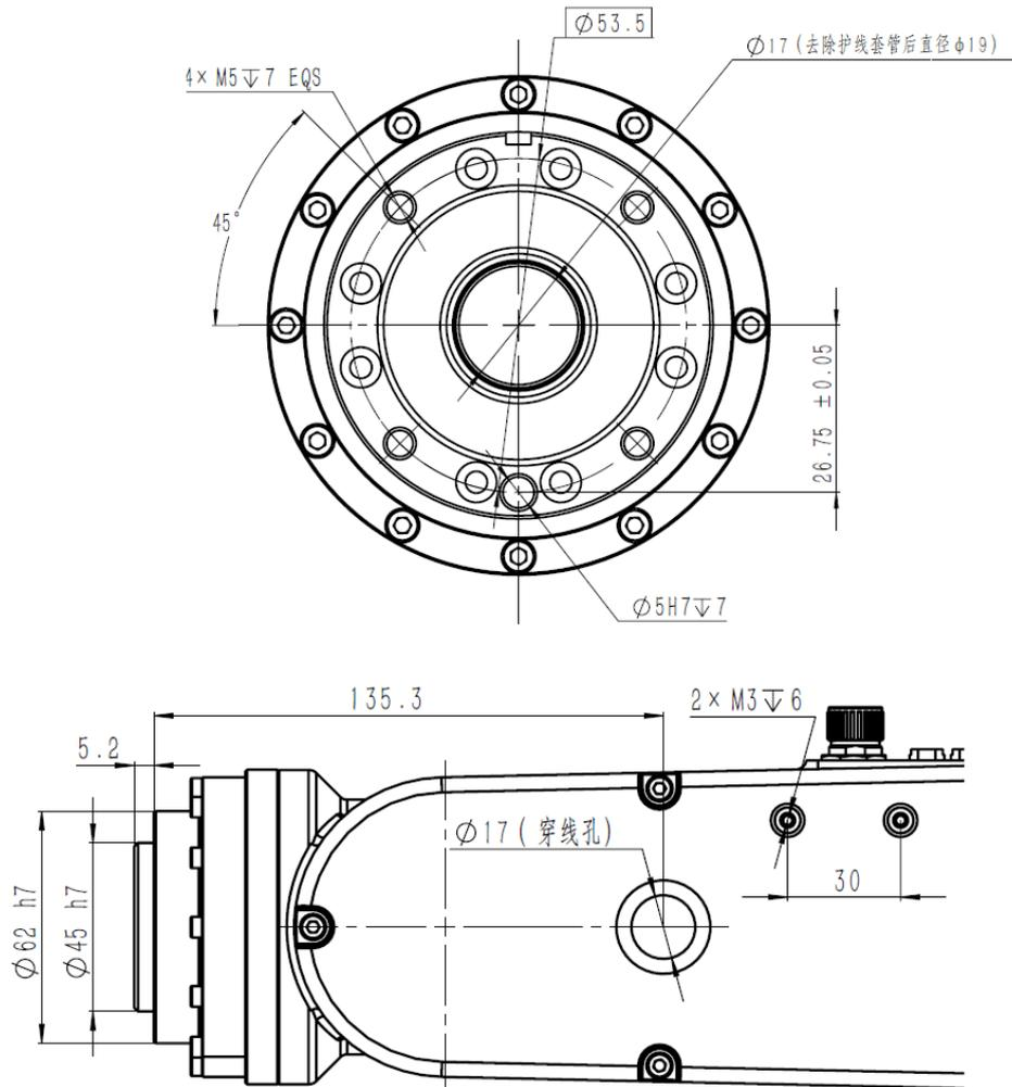
图 6-6 AIR4-560C(-HW)操作机腕部法兰尺寸示意图
