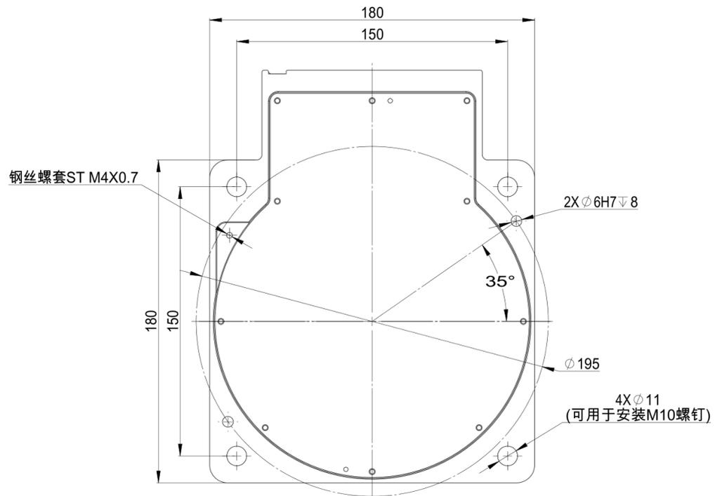
图 3-3 AIR4-560C(-HW)操作机底座接口尺寸
