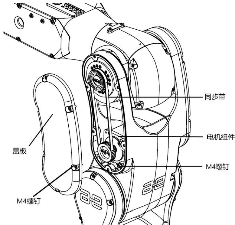
图 10-5 J3 轴同步带更换示意图
